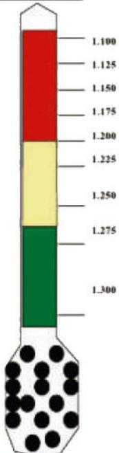
O Densímetro é uma espécie de ferramentas ideal para análise de carga (medir o peso específico de um fluido mergulhado em chumbo) com uma polheta escalada entre 1100 a 1300g/cm<sup>3</sup>.
