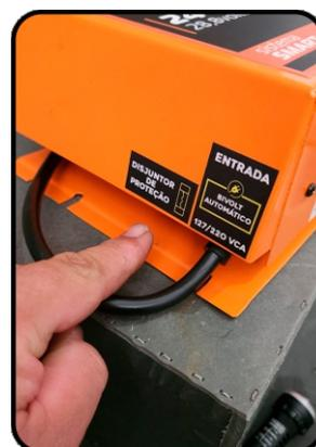
**Figura 12:** Atenção, o disjuntor deverá ser acionado (ligado) antes de ligar o carregador na energia.
