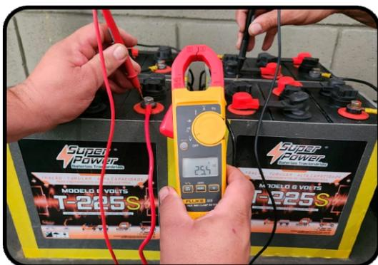
**Figura 5:** Conferir a tensão (v) do banco de baterias, para aplicar o carregador correto 24V ou 48V, antes de seu funcionamento.
